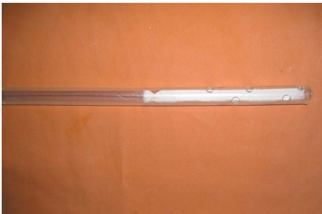
Рис.4.2.6. Зовнішній вигляд дренажний пристрою після уведення сорбенту
