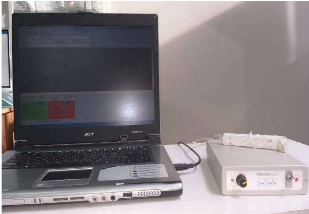
Рис. 2.16. Зовнішній вигляд оптико-електронного приладу діагностування стану периферичного кровообігу.
