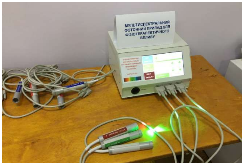
Рис. 2.11. Мультиспектральний фотонний прилад для фізіотерапевтичного впливу «MultiSpectr-001».
