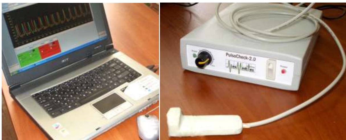
Рис. 2.4. Оптико-електронний прилад для оцінювання тканинної мікроциркуляції.
